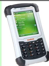
NAUTIZ X7 является полнофункциональным КПК и разработан для экстремальных условий эксплуатации с защитой от внешних воздействий по стандартам IP 67 и MIL-STD-810G. Он выдерживает 26 падений с высоты 1.2 м и погружение в воду на глубину 1 метр на 30 минут. Защищен от песка и пыли. Может быть использован в качестве управляющего компьютера для измерителя МПП-ВП.
