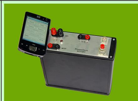
Цифровой электроразведочный измеритель МПП-ВП аппаратуры АИЭ-2 предназначен для измерения постоянных напряжений и ЭДС переходного процесса. Приемником сигнала является незаземленная петля или индукционный датчик при измерениях МПП и заземленная линия с неполяризуемыми электродами при измерениях ВП.
